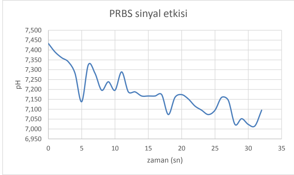
Şekil 5.1 PRBS etkisi ile çıkış değişkeni değişimi
