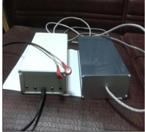
b- EMG Cihazı Prototipi (4 kanallı) önden görünüş, soldaki ön ve ana yükselteç, programlanabilir akım kaynağı, veri alım kartı, sağdaki prototip için özel tasarlanan besleme kaynağı iç görüntüsü
