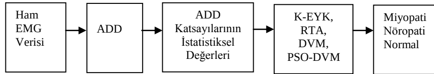
Şekil 1.14. Önerilen Sistemin Blok Diyagramı (Subasi, 2013)
