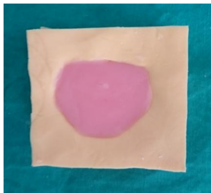
Şekil 0-2: Kalıplara Soğuk Pembe Akrilik Dökülmesi
