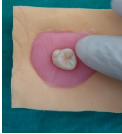
Şekil 0-3:Dişlerin Akrilik Bloklara Gömülmesi
