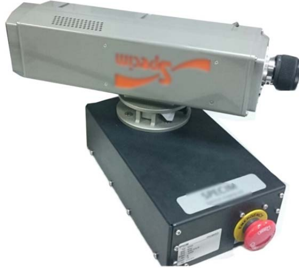
Şekil 2.2 YAZGI Laboratuvarı'ndan alınmış hiperspektral kamera görüntüsü
