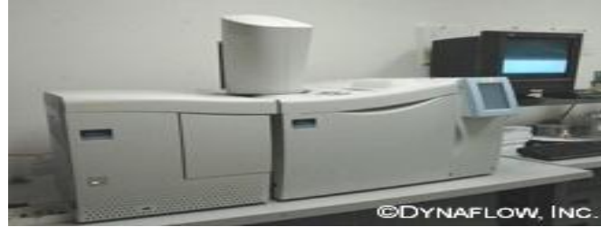
Şekil 3.4. Uçucu yağının içeriğini belirleyen cihazdan bir görünüm
