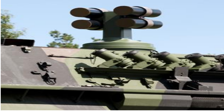
Resim 1.1. Tank üzeri dört podlu fırlatma aracı (DIEHL BGT Defence AvePS) ( http://www.diehl.com/en/diehl-defence/.html )
