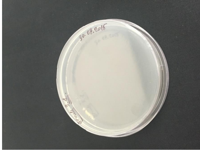
Şekil 9.28 Elektrospinning yöntemi ile kaplanan 3.1 numunesine ait petri ekim sonucu Elektrospinning yöntemi ile yapılan kaplama sonucu bakteri testi uygulanan 3 nolu numunenin kaplanan yüzeyinde (3.1) organizma büyümesi gözlenmemiştir (Şekil 9.28).
