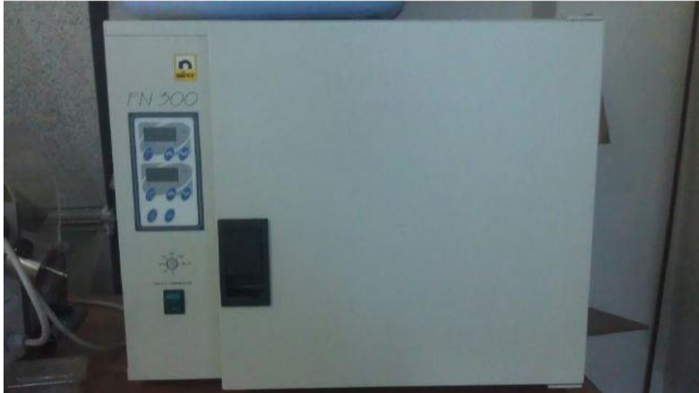
Şekil 8.6 Solvotermal işlemin yapıldığı cihaz
