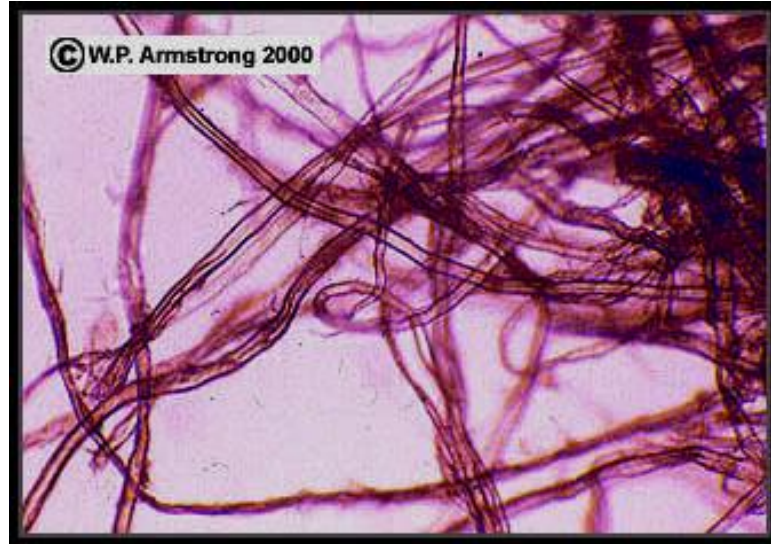
Şekil 2.2 Selüloz fiberlerinin ağ örgüsüne ait optik mikroskop görüntüsü [13]
