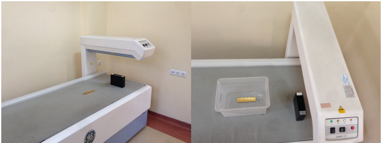
Şekil 14 Ölçüm yapılan DXA cihazının kalibrasyon aparatları ile birlikte görünüşü
