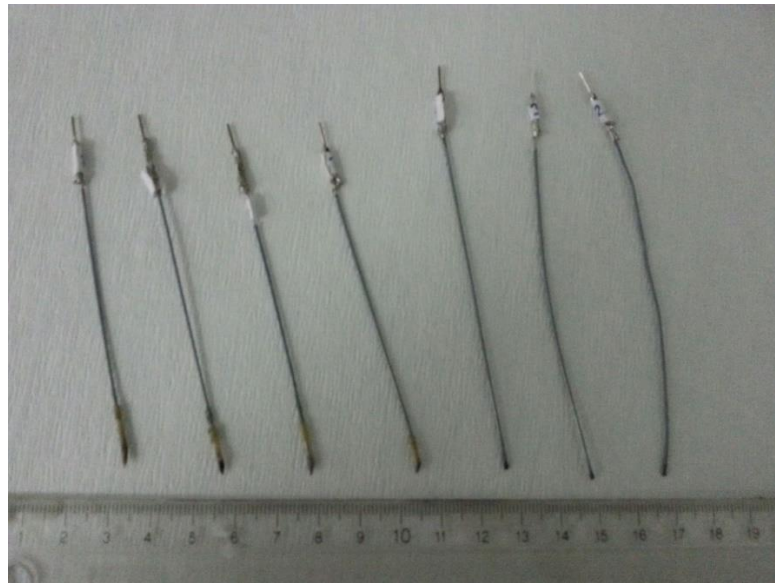
Şekil 5.1 Üretilen kalsiyum seçici elektrotlar
