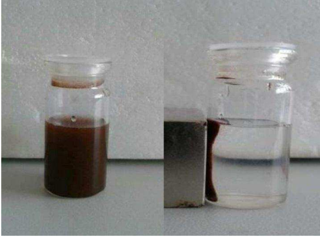
Şekil 3.2. \text{Fe}_3\text{O}_4 -Kitosan ( \text{Fe}_3\text{O}_4 -KS) nanoparçacıklarının mıknatıs yardımıyla ayrılması
