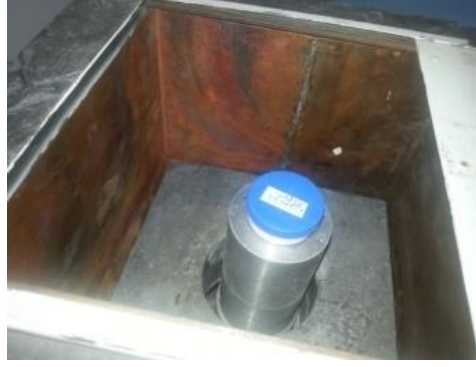
Şekil 3.13. Gama spektrometrisi dedektör üzerine ölçüm için yerleştirilen örnek numune
