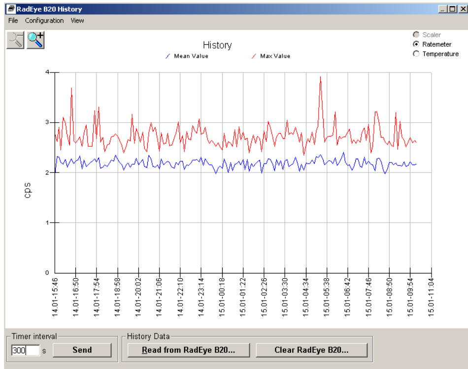
Şekil 3.6. Radeye cihazında bir numune için alınan ölçümlere ait doz hızı verilerinin zamana bağlı değişimi (mavi çizgi ortalama sayım hızı değerlerini, kırmızı çizgi ise 300 saniyelik okuma aralığı içinde saptanan maksimum sayım hızı değerlerini göstermektedir)
