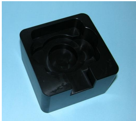
Şekil 3.4. Doz hızı ölçümlerinde kullanılan numune tutucu aparat
