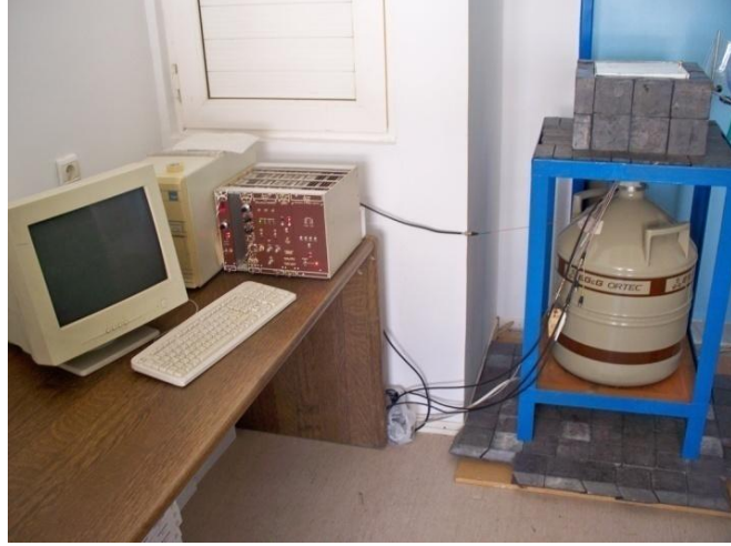
Şekil 3.10. Gama spektrometrik analiz için kullanılan dedektör sistemi
