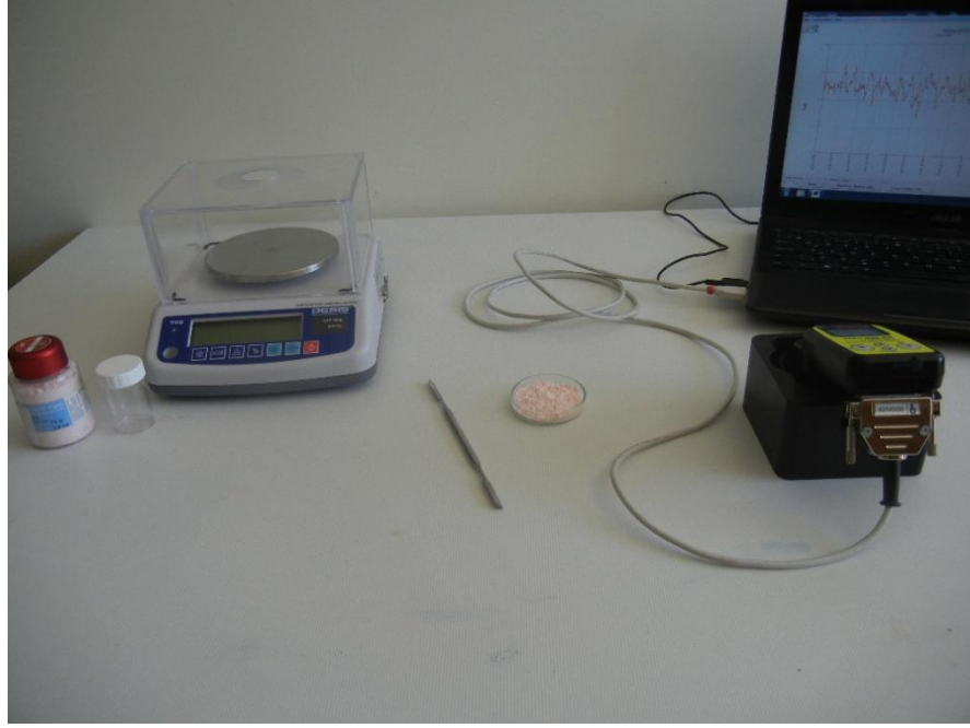
Şekil 3.9. Porselen tozu numunelerine ait doz hızlarının ölçülmesi için kullanılan deneysel düzenek
