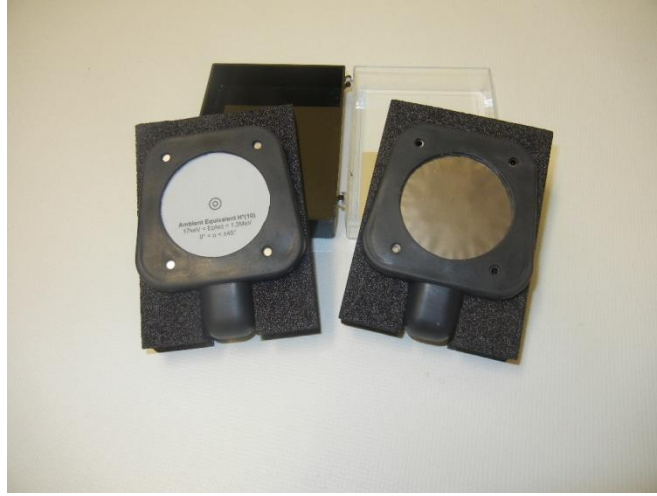
Şekil 3.3. GM dedektörü ile birlikte kullanılabilen H*(10) gama filtresi (solda) ve alfa bloklayıcı filtre (sağda)
