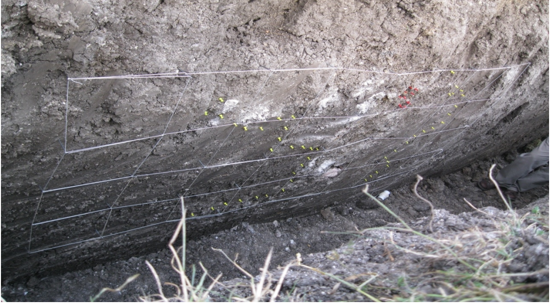
Şekil 1.12 Hendek duvar temizliği, düzeltilmesi ve karelej sistemiyle kareleyip fay izinin diğer doğal toprak yapısından renkli çiviler yardımıyla ayırma.
