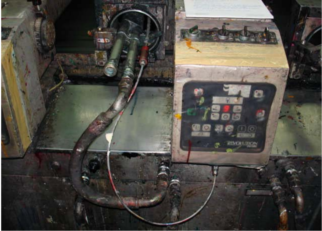
Şekil 10.19. Baskı patı hortumunun taşıyıcı rakleye yerleştirilmesi
