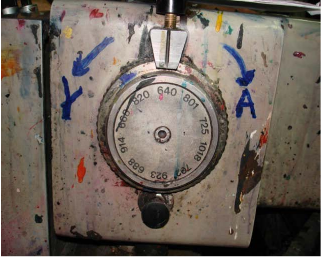
Şekil 10.15. Şablon çevre ölçüsü ayar kısmı
