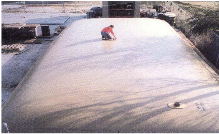
Şekil 6.6. Su veya petrol tankı yapısı
