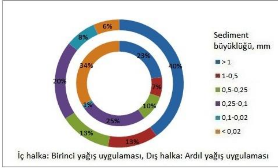
Şekil 4.26. Typic Xerorthent toprağın 1-2 mm büyüklüğündeki agregatlarının yerleştirildiği PAM uygulanmış tavalardan yüzey akış ile taşınan sedimentin parçacık büyüklük dağılımları
