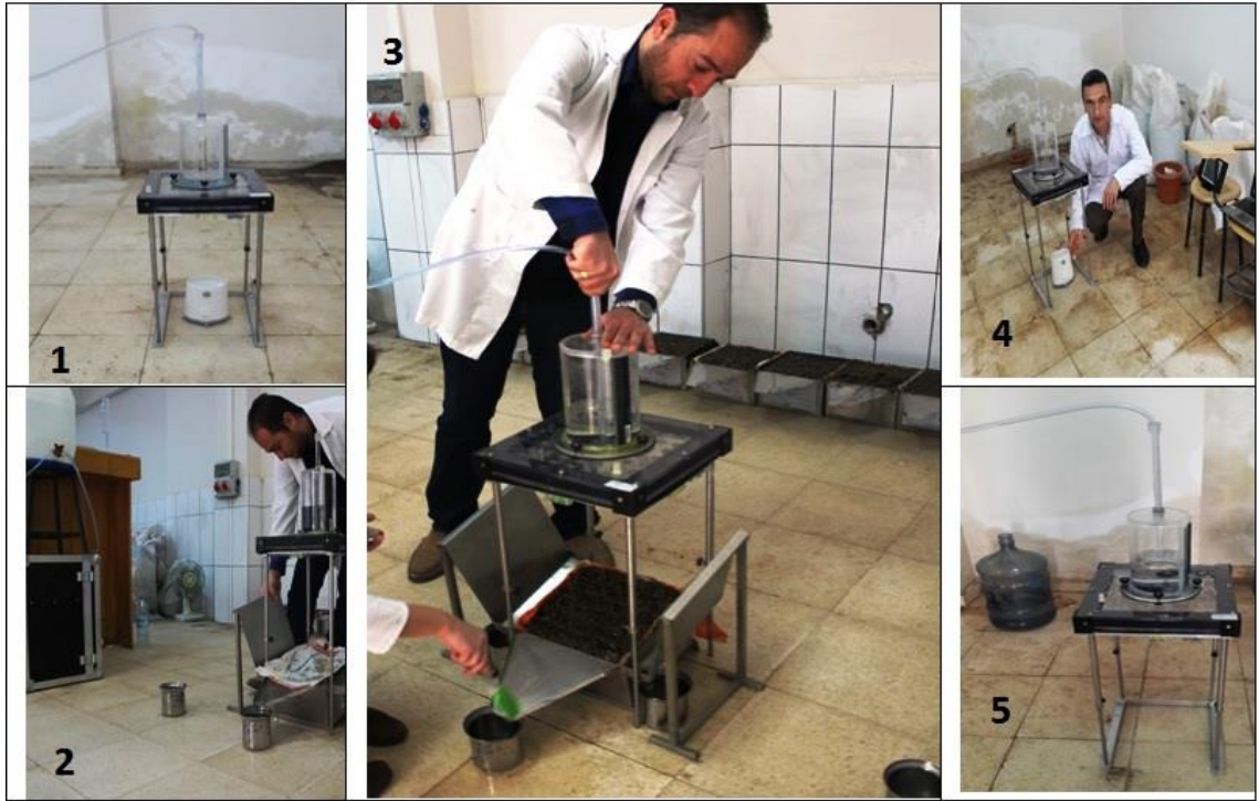
Şekil 3.4. Yağış simülasyonunun kalibrasyonu ve yağış ölçümlerine ait bazı fotoğraflar (1: Simülasyon ve plüviyometrenin ön görünümü, 2: simülasyonun kullanıma hazırlanması, 3: hava borusunun yüksekliğinin ayarlanması, 4: hava istasyonu setinin bilgisayar ve analog bağlantı görünümü, 5: simülasyonun su yükü haznesi ve su tankı bağlantısının görünümü)
