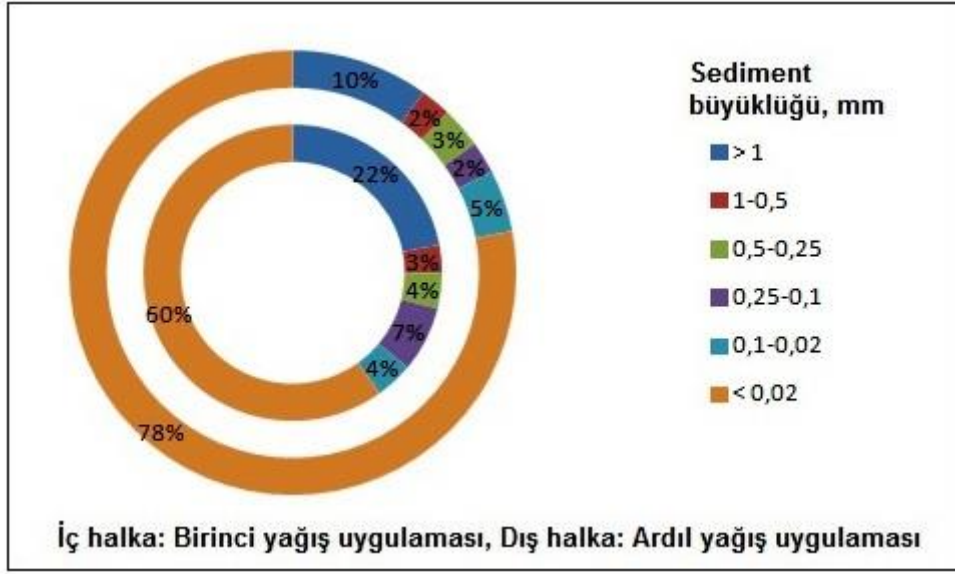
Şekil 4.8. Typic Xerochrept toprağın 1-2 mm büyüklüğündeki agregatlarının yerleştirildiği PAM uygulanmış tavalardan yüzey akış ile taşınan sedimentin parçacık büyüklük dağılımları
