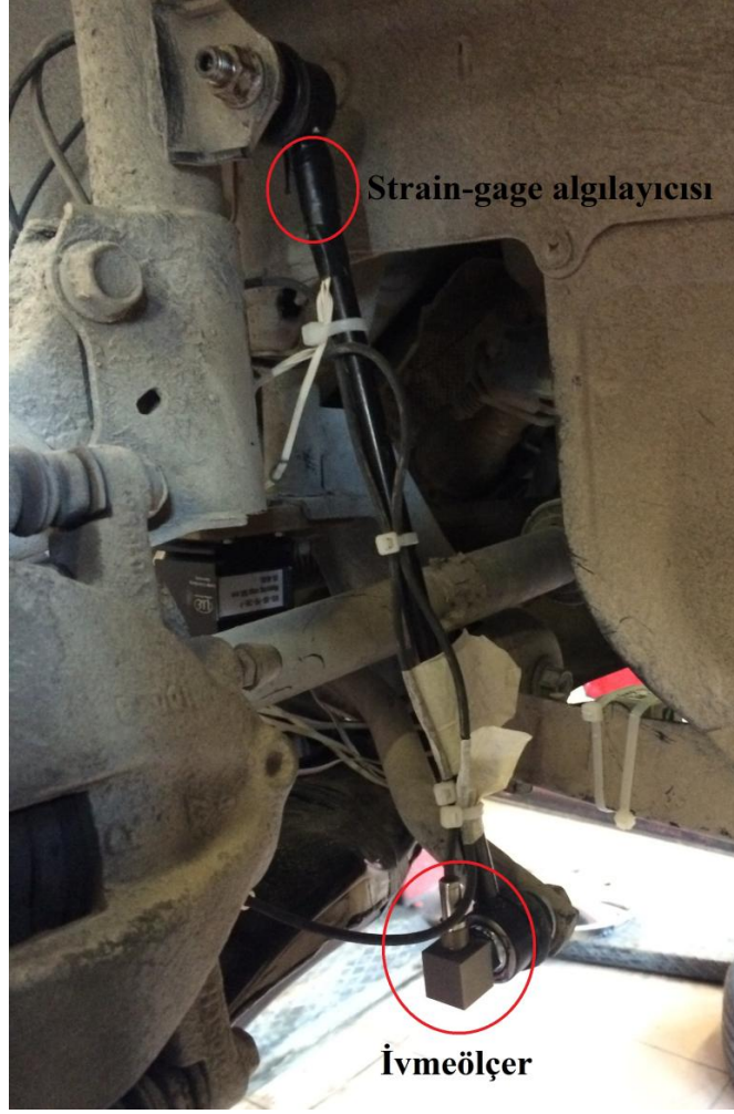
Şekil 4.7. Stabilizer rota algılayıcıların yerleştirilmesi
