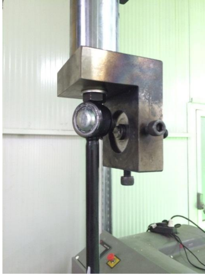
Şekil 5.6. Stabilizer rotun kırılmasıyla testin sonlanması
