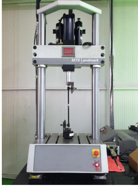
Şekil 5.3. Dinamik testlerin gerçekleştirildiği MTS test cihazı
