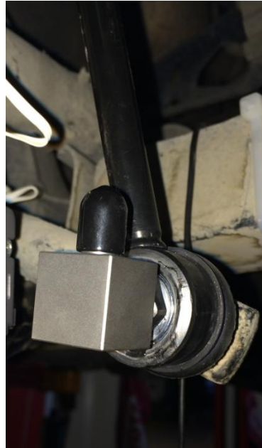
Şekil 4.6. İvmeölçerin stabilizer rota yerleştirilmesi
