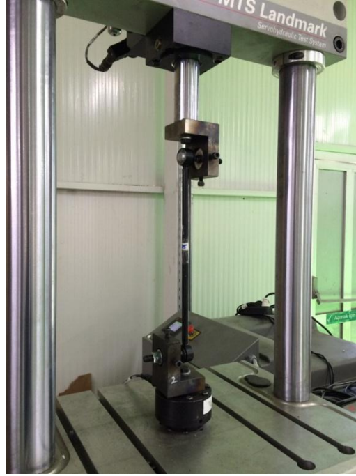
Şekil 5.4. Stabilizer rotun test cihazına bağlanması
