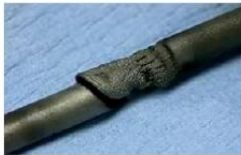
řekil 4.3 Ark buharlařtırma sonucunda oluřmuř grafit silindir; silindirin ortasındaki kısmın merkezinde KNT’ler yoėunlařmıř halde bulunmaktadır[33]
