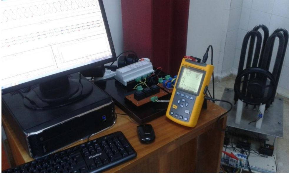
Şekil 4.40. Üç fazlı yük için kurulan deney düzeneği.
