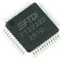
Şekil 4.33. Seri port – USB çevrim entegresi (Future Technology Devices International, 2011).
