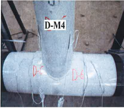
c) Kiriş deforme olmuş hal genel görünüm
