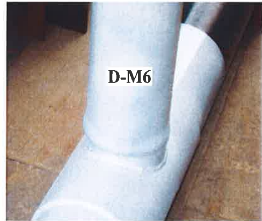
b) Şekil değiştirmiş durum yan görünüm
