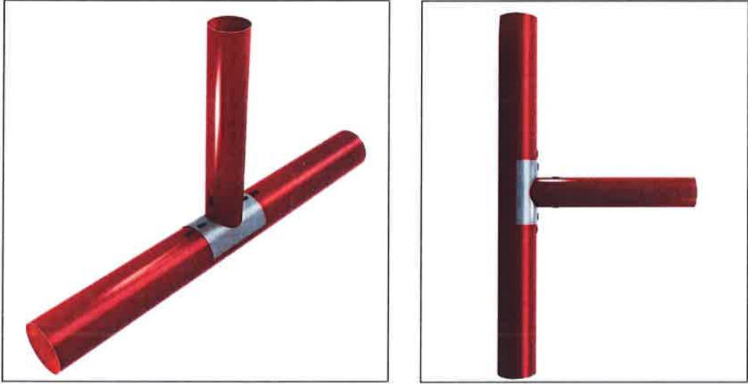
c) Başlık levhalı kiriş-kolon birleşim detayı genel görünümü
