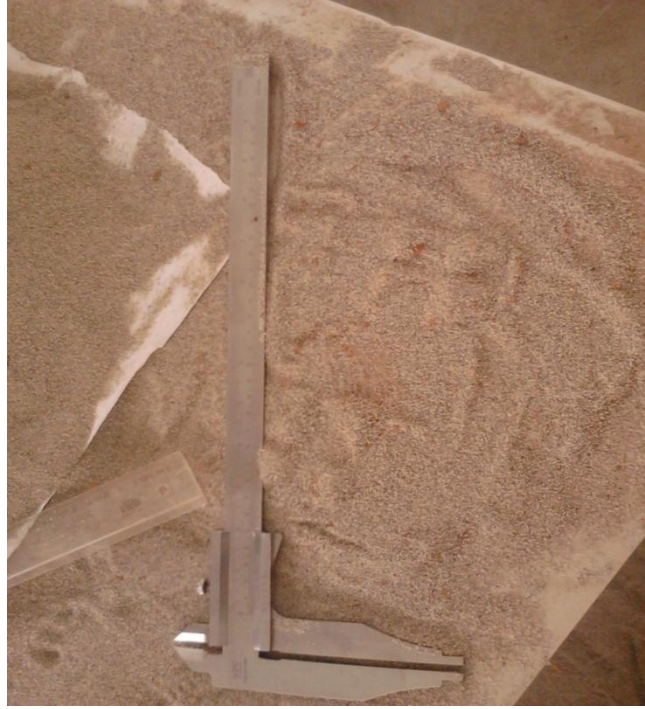
Resim 5.1. Boyut muayenesi deneyinde kullanılan 1mm hassasiyetli kumpas
