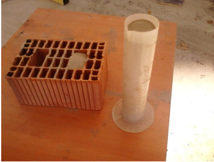
Resim 5.6. Kum doldurma metodunda kullanılan elenmiş kum ve ölçü aleti
