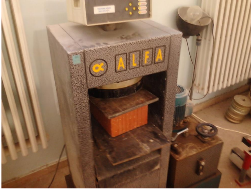
Resim 5.9. Kagir birim numunelere uygulanan basınç dayanım deneyi
