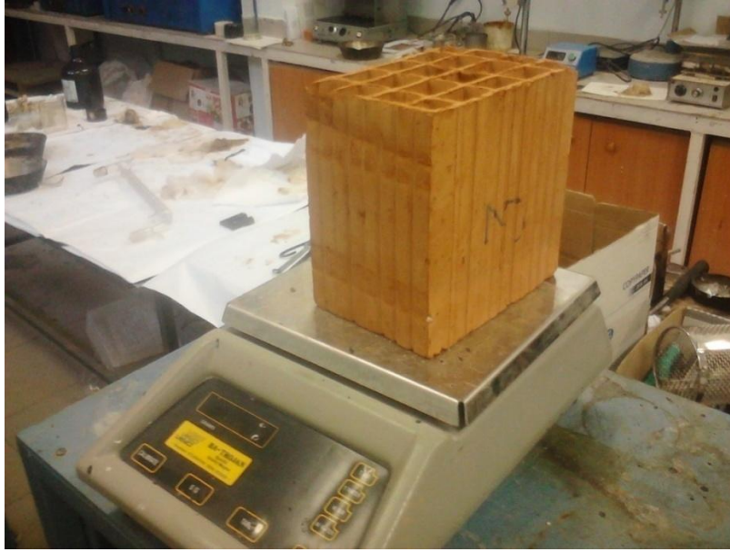
Resim 5.3. Suya doymun haldeki numunelerin havadaki kütlelerinin bulunmasında kullanılan tartı aleti
