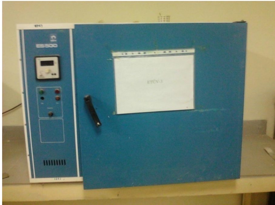
Resim 5.7. Kil kagir birimlerin (105 \pm 5)^{\circ}\text{C} 'de kurutabilen etüvde kurutulması
