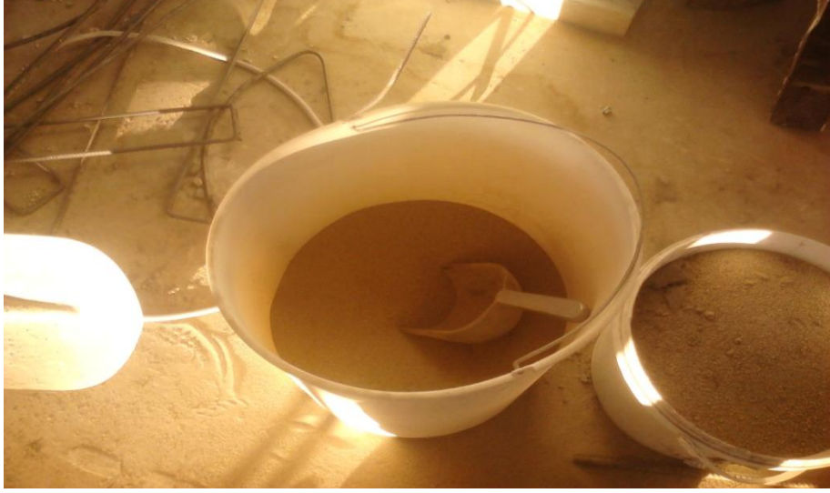
Resim 5.5. Net hacim ve boşluk yüzdelerinin tespitinde kullanılan elenmiş kum
