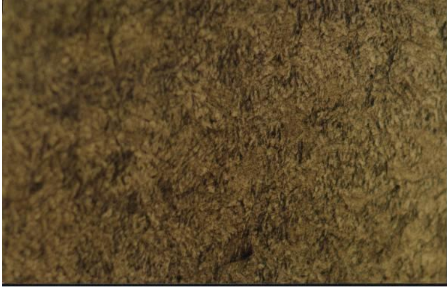
Resim 4.3 SAE 8620 Malzemesinin Sementasyon uygulanmadan önceki mikroyapısıX200
