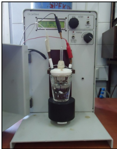
Resim 3.1. Elektrokimyasal deneylerde kullanılan üç elektrotlu hücre sistemi
