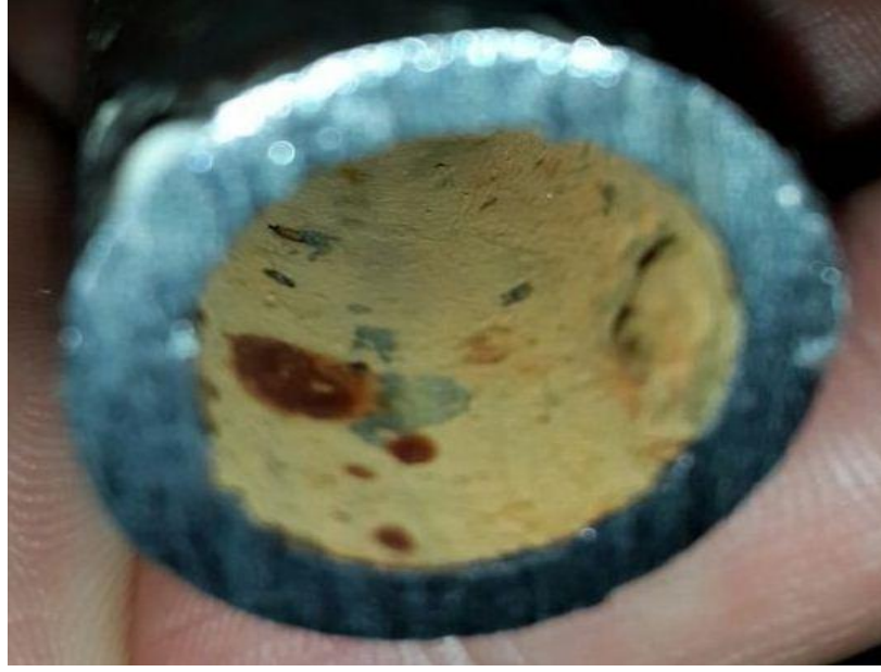
Resim 2.1 Demir boru yüzeyinde kırmızı kahverengi lekeler ve \text{CaCO}_3
