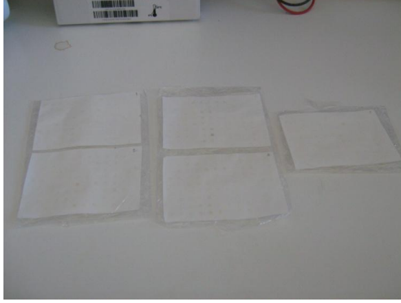
Şekil 3.10. CSPD ile muamele gören membranların plastik filme sarılması.
