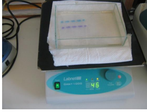
Şekil 3.1. Boyama sonrası jelden istenmeyen materyallerin uzaklaştırılması.
