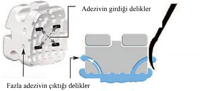
Şekil 3.2 : G&H seramik braket taban yüzeyi dizaynı.
