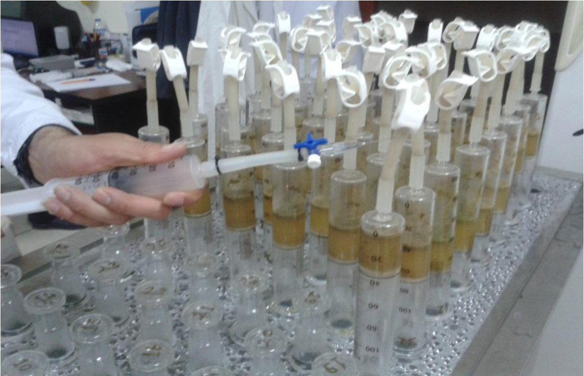
Şekil 3.17. Gaz ölçümlerinin yapılması
