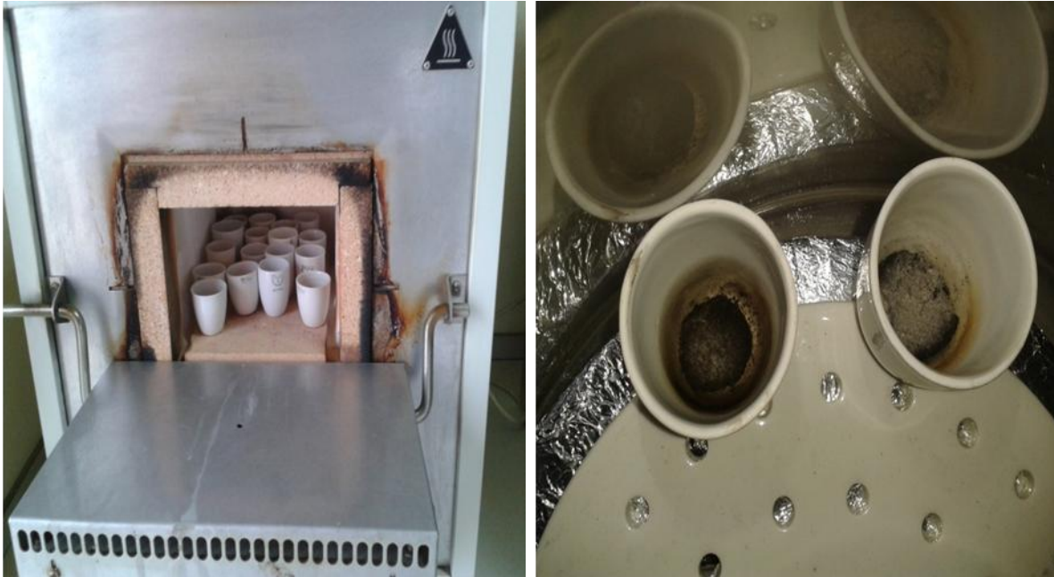
Şekil 3.11. Kül fırınında porselen krozelerde ham kül tayini
