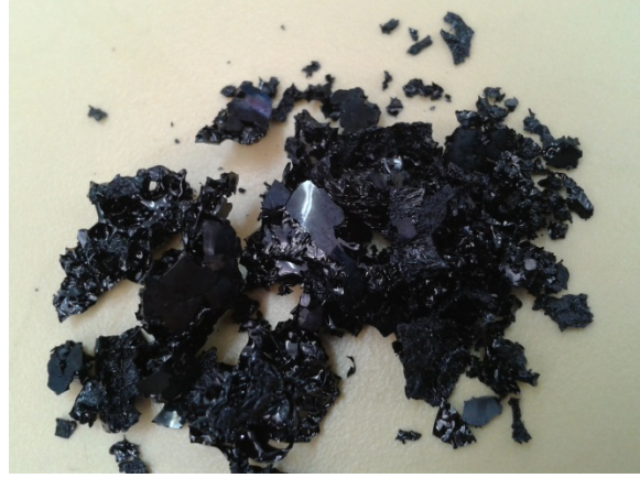
Şekil 10.13. Biyokütle katranından elde edilen biyo-zift örneği
