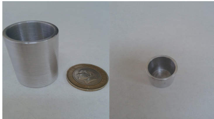
Şekil 9.5. Köpükleşme işleminde kullanılan alüminyum kalıp
