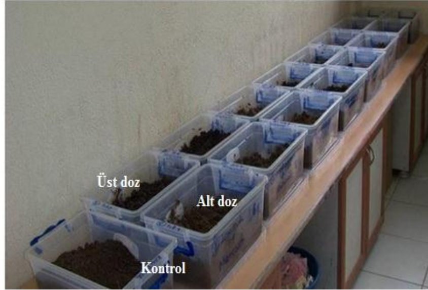
Şekil 3.24 Synchytrium endobioticum ile bulaşık toprađa fungusitlerin alt ve üst dozda kompostu ıslatacak miktarda uygulanması ve inkubasyonu
