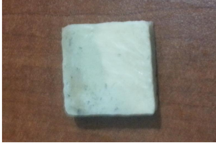
Şekil 3.15. 30x30x10 mm boyutlu kompozit dolgu materyali
