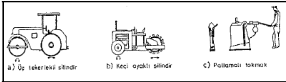
Şekil 2.5. Mekanik stabilizasyon için en çok kullanılan aletlerin şematik çizimleri.
