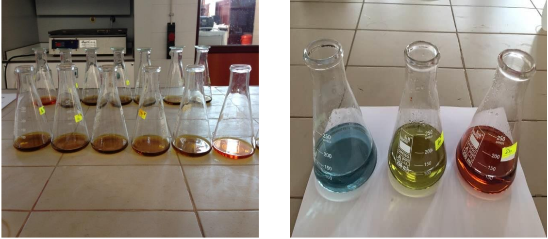
Şekil 3.6. TSE 5869 ISO 5073 standartlarına göre yapılan titrasyon testlerinde elde edilen ürünler.
