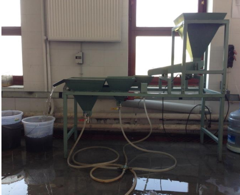
Şekil 3.9. Leonarditin üç kompartımanlı hidrolik sınıflandırıcı ile zenginleştirilmesinde kullanılan deney düzeneđi.
