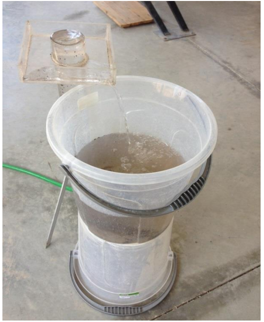
Şekil 3.7. Leonarditin düşey akışkan yatakta su ile zenginleştirilmesinde kullanılan deney düzeneği.
