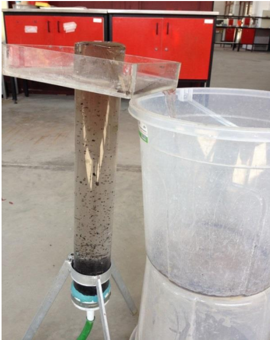
Şekil 3.7. Leonarditin düşey akışkan yatakta su ile zenginleştirilmesinde kullanılan deney düzeneği.
