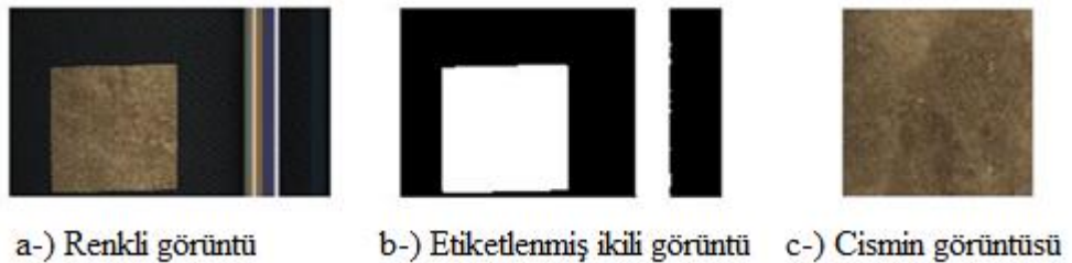
Şekil 5.14. Eşikleme işlemi sonucunda cismin tespiti
