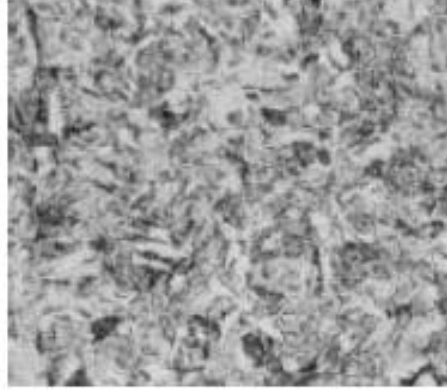
Şekil 2.7: Temperlenmiş martenzitik çelik (M190), 500x büyütme [3].
