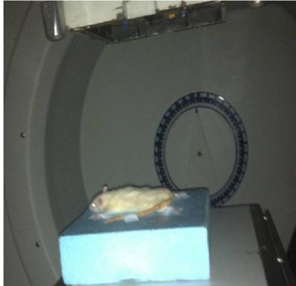
Resim 2: Kobalt 60 cihazı ve anestezi sonrası sıçanın radyoterapi için pozisyonlanması
