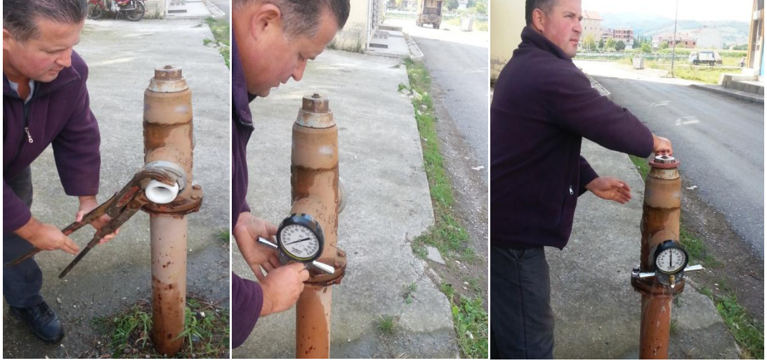
Şekil 3.16 Kalıntı hidranta basınç ölçerin yerleştirilmesi ve basınç değerinin okunması
