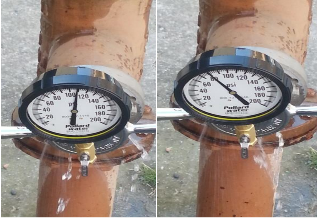
Şekil 3.18 Akım hidrantı açıldıktan sonra kalıntı hidranttaki basınç değişimlerinin ve nihai basıncın gözlenmesi
