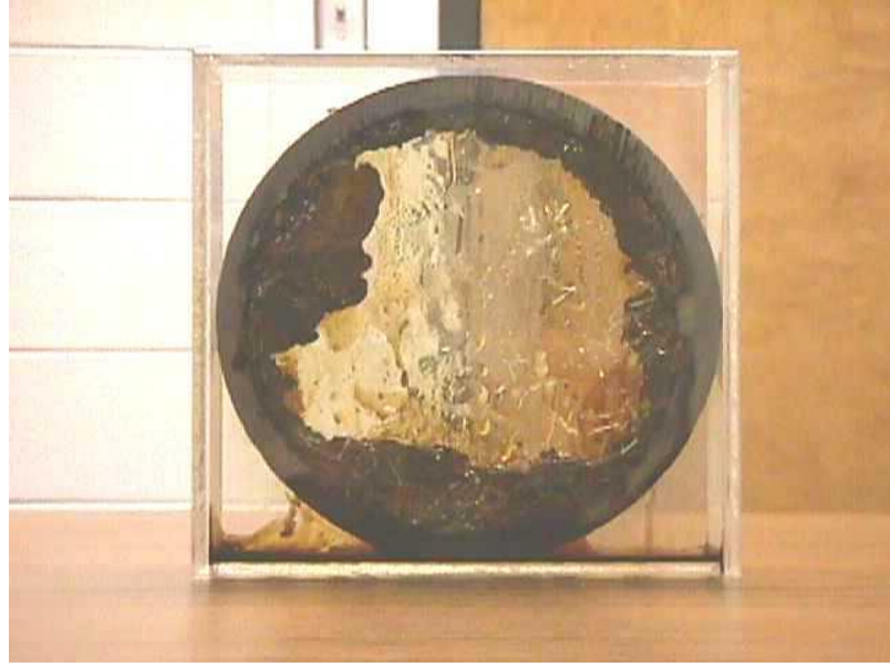
Şekil 2.10 Boruda korozyon ve tortu oluşumu (ECAC, 1999)
