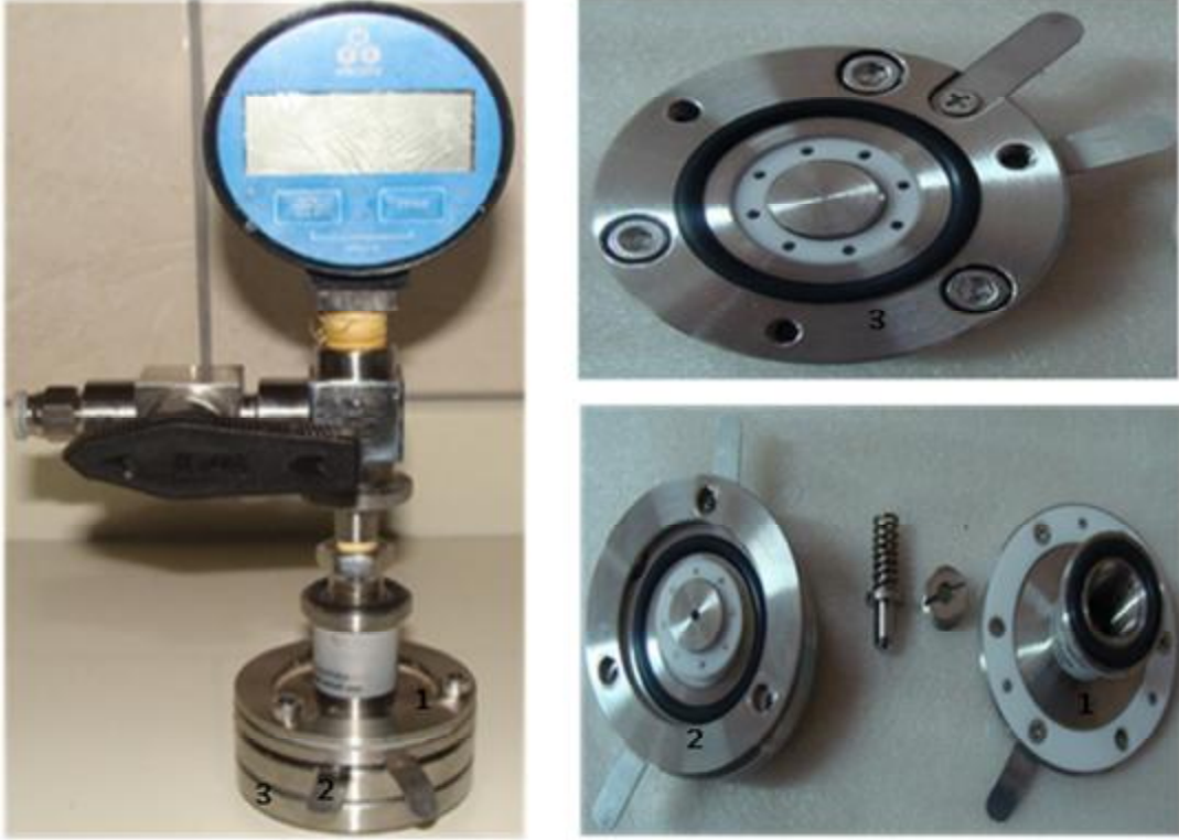
Şekil 3.1. Pil hücresi için elektrolit ve gaz giriş bölmesi (1), akım toplayıcı ve katot bölmesi (2), akım toplayıcı, referans ve anot bölmesi (3)
