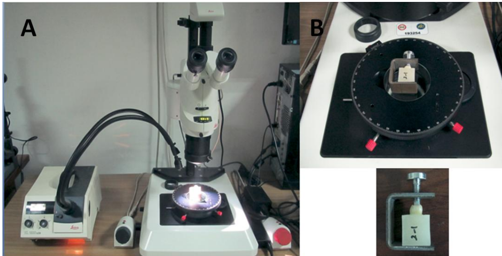
Şekil 3.32. A. Leica MZ 16A (Leica Microsystems, Switzerland) ve Leica KL 1500 LCD ışık kaynağı, B. Restorasyonların Ölçüm Yapılırken Sabitlenmesi
