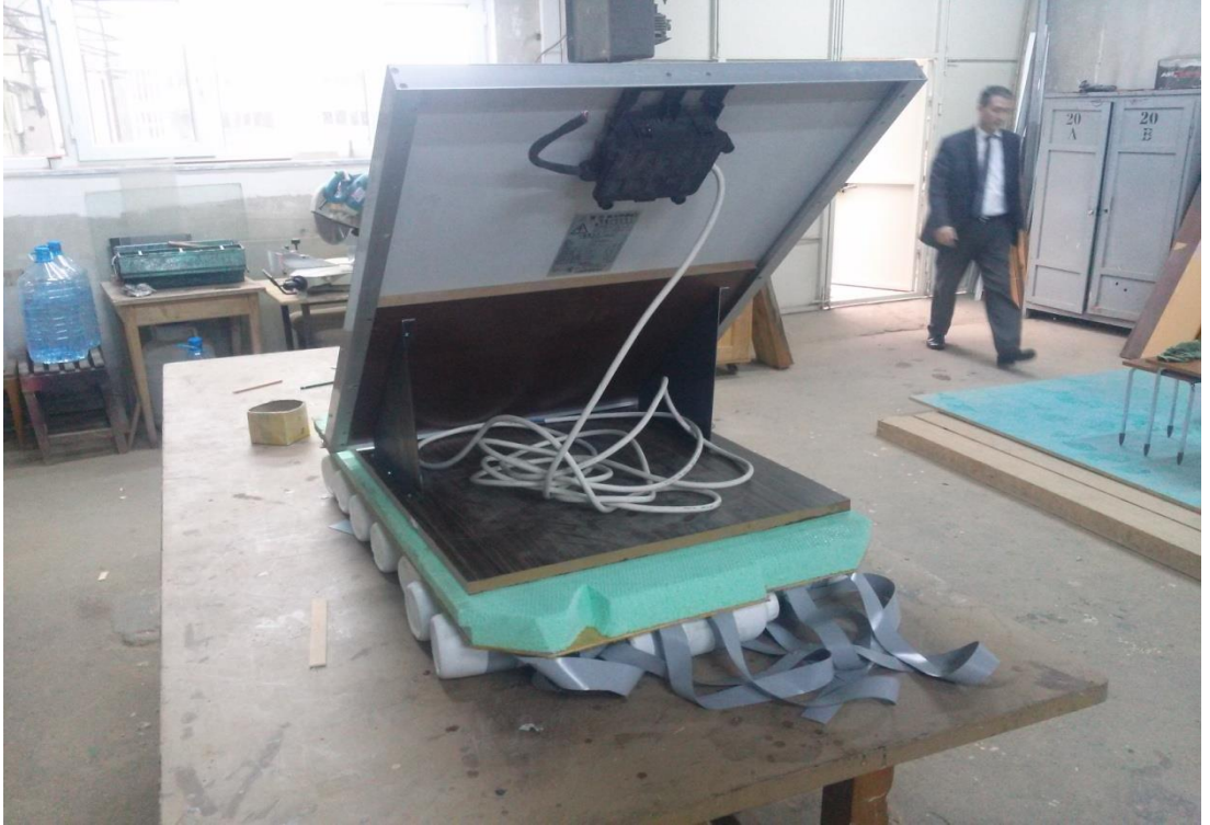
Şekil 5.3 : Yüzer fotovoltaik panel platformu imalat tamamlandıktan sonra.
