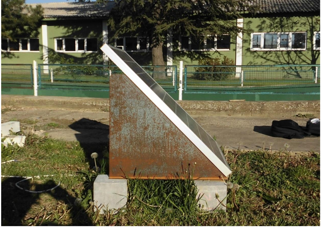
Şekil 5.5 : Beton bloklar üzerine kurulu sabit platform toprak(kara) yüzeyinde.
