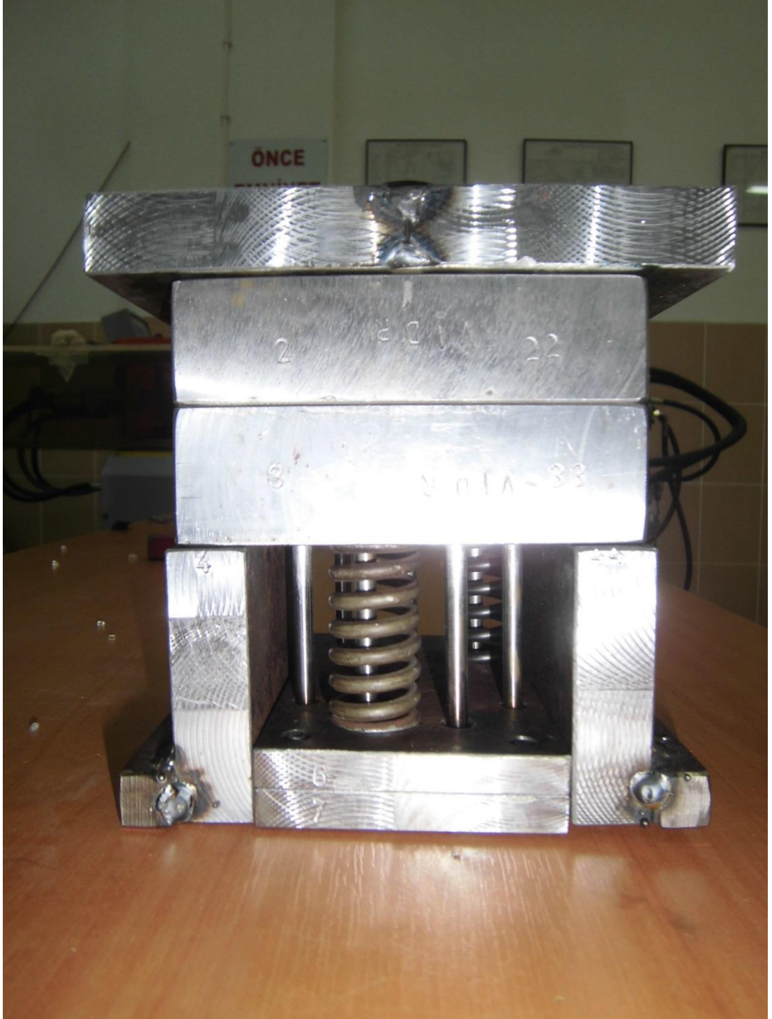
Şekil 3.6. AISI H11 sıcak iş takım çeliğinden yapılmış kalıp
