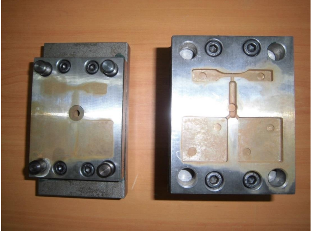
Şekil 4.9. PVC enjeksiyonu sonrasında AISI Ç1040 karbon çeliğinde oluşan korozyon
