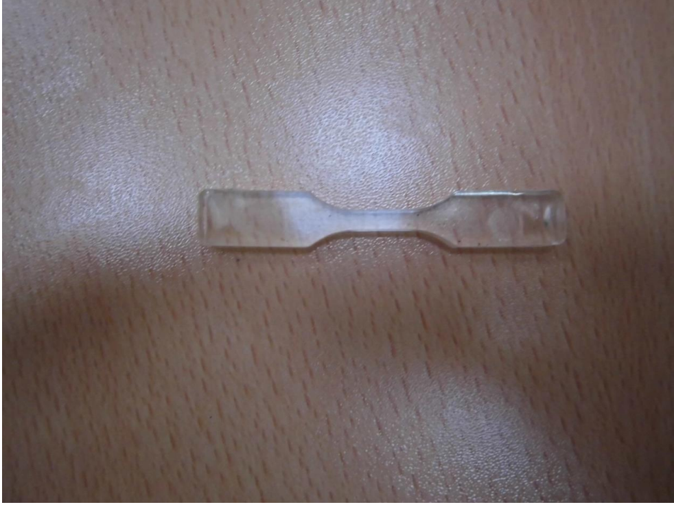
Şekil 3.12. Enjeksiyon işleminden sonra AISI H11 sıcak iş takım çeliğinden yapılmış kalıptan edilen çekme deneyinde kullanılacak PVC numunesi
