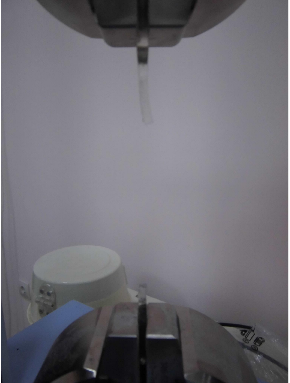
Şekil 3.18. Universal germe çekme test cihazında kopmuş numune
