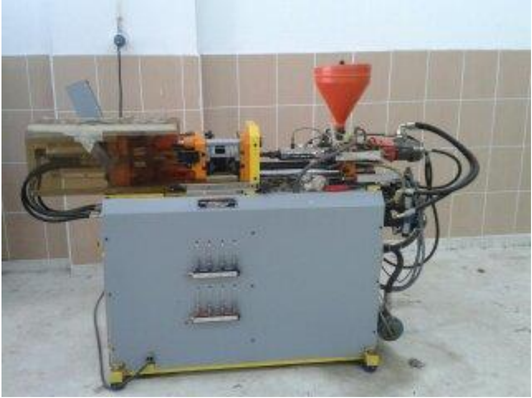
Şekil 3.9. Kalıpların bağlandığı yatay plastik enjeksiyon makinesi
