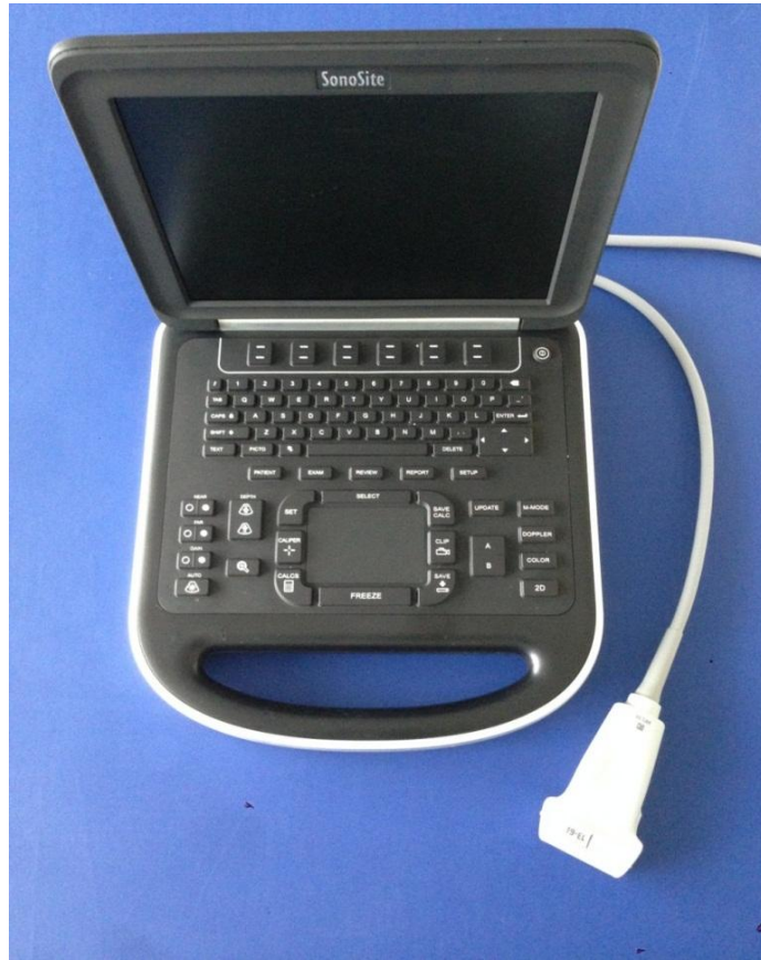
Resim 5: Sonosite Edge US Ünitesi ve HLF38x/15-6 Lineer Transduser (Dr. Özkan PARLAK)
