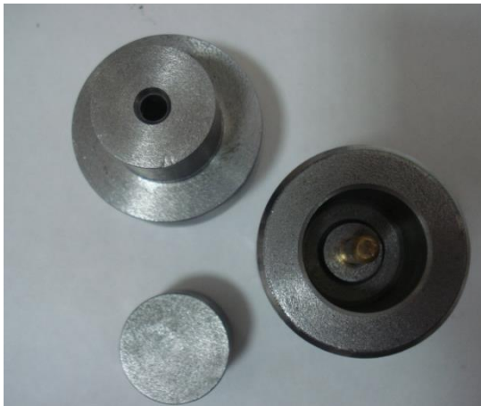
Resim 7.6. Küçük parçaların üretildiği kalıp
