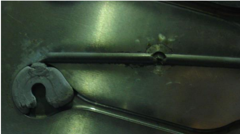
Resim 7.4. Kalıp üzerinde eksik dolum (enjeksiyon parametreleri 140 °C – 1000 bar - 10 cm 3 /s (%65 Ti-6Al-4V))
