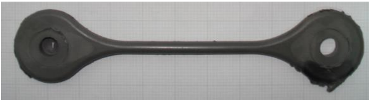
Resim 7.10. %65 (H)Ti-6Al-4V + %35 Bag besleme stokundan üretilen numune
