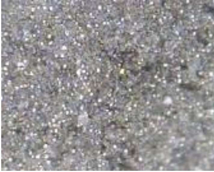
Resim 6.3. Sıcak karışım yapılmış %50 Ti-6Al-7Nb + %50 B besleme stoku optik mikroskop görüntüsü
