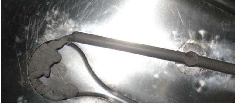
Resim 7.2. Kalıp üzerinde eksik dolum (enjeksiyon parametreleri 140 °C – 600 bar - 10 cm 3 /s (%65 Ti-6Al-4V))
