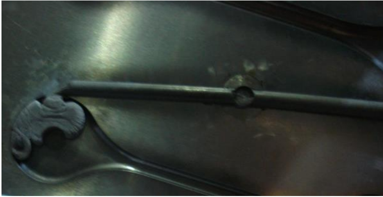
Resim 7.3. Kalıp üzerinde eksik dolum (enjeksiyon parametreleri 140 °C – 900 bar - 10 cm 3 /s (%65 Ti-6Al-4V))
