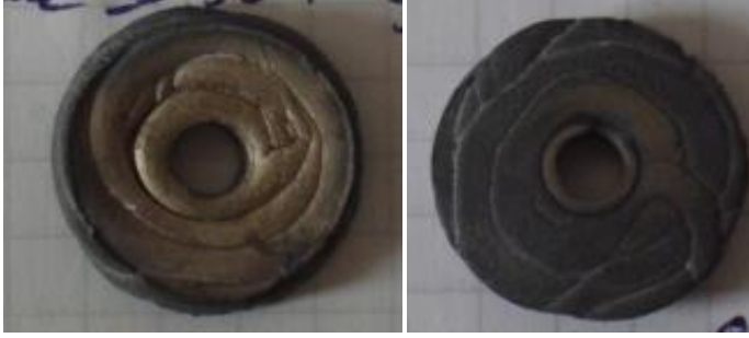
Resim 7.7. 1300 °C'de 1 saat sinterlenmiş Ti-6Al-4V numune
