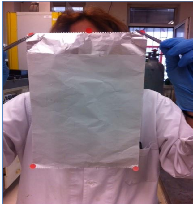
Şekil 2.4. Elektrospinning işlemi sonrası alüminyum folyo üzerinde elde edilen nanofiberler membranının görüntüsü.
