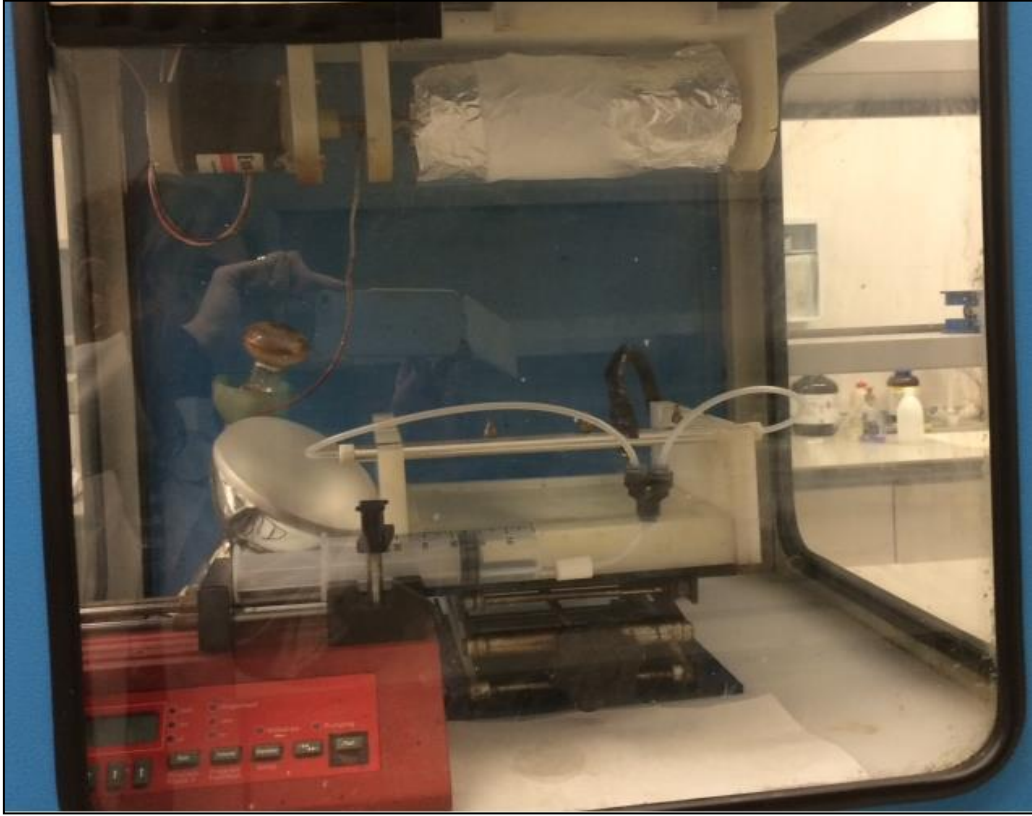
Şekil 2.1. Nanofiber Membranların hazırlanması için kullanılan elektrospin düzeneği.
