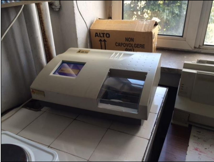
Şekil 2.2. Hücre canlılık testleri için kullanılan spektrofotometre.
