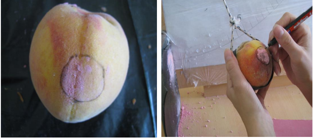
Şekil 3.6. Çarpma testi sonrası şeftalinin görünüşü
