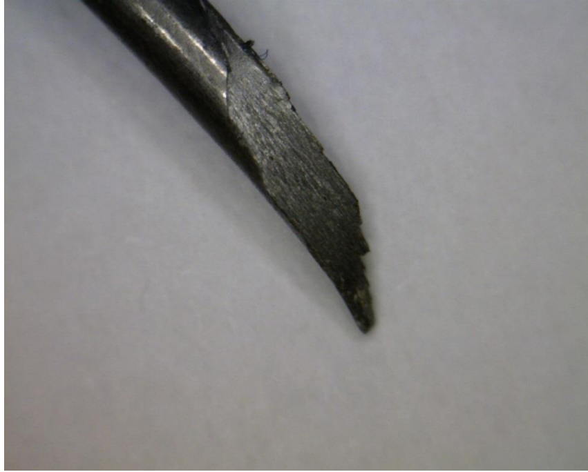
Şekil 11.28 : Delaminasyon kopması örneği.
