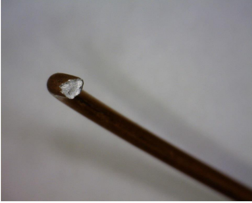
Şekil 11.29 : Bölgesel inklüzyon kaynaklı kopma örneği.
