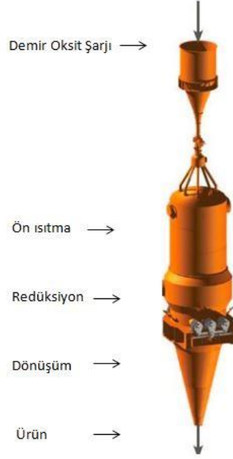
Şekil 3.1 : Midrex sünger demir üretim prosesinde işlem basamakları [5].
