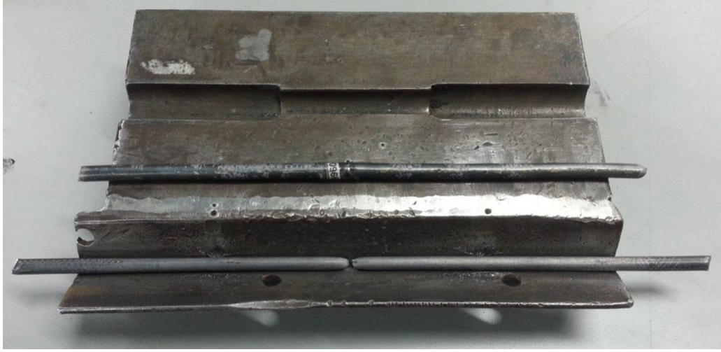
Şekil 11.9 : Numunelerin çekme testi öncesinde ve sonrasında görünüşleri.
