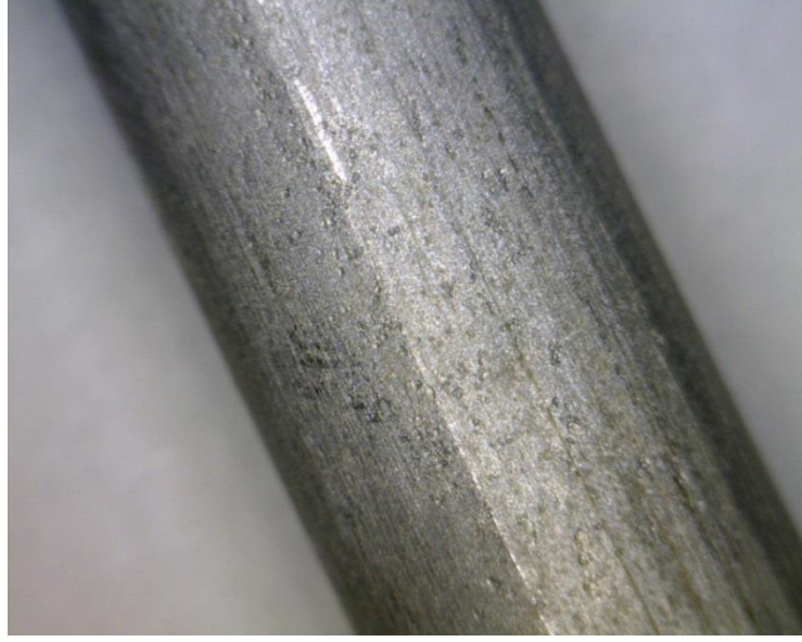
Şekil 11.31 : Çok fazla tufal oluşumuna izin verilmeyen filmaşın.
