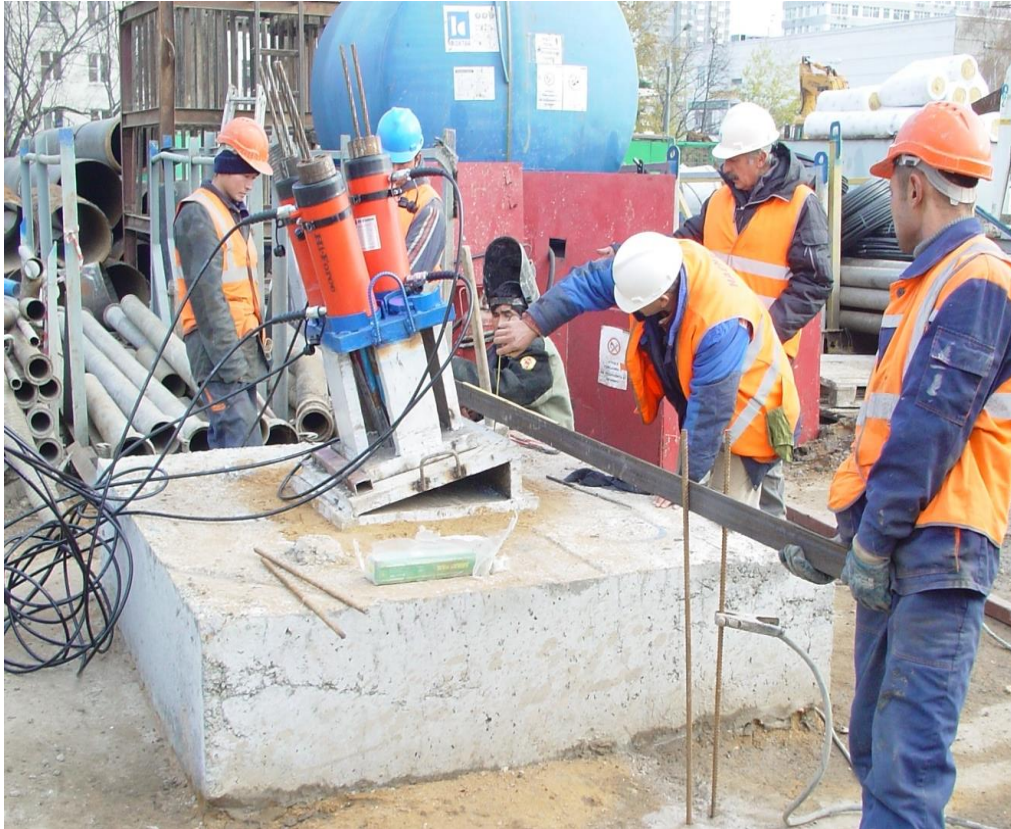
Şekil 5.9 : Killi kum-siltli kil formasyonlarında gerçekleştirilen SBMA deney ankrajı; T_{maks} = 1295 \text{ kN} , P_{germe} = 600 \text{ kN} (Kuntsevo Projesi, KASKTAŞ 2011)
