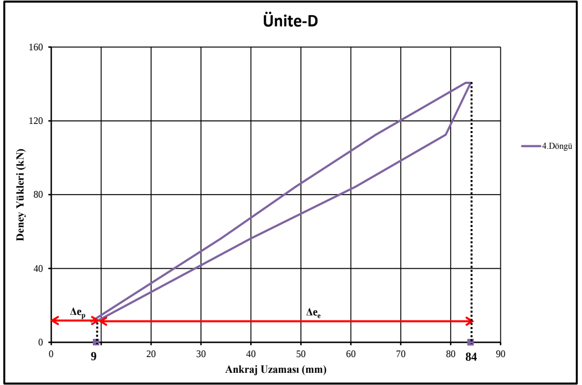
Şekil 6.47 : Deney Ankrajı-4: Yük Uzama Grafiği (125% Yük Döngüsü-Ünite D)
