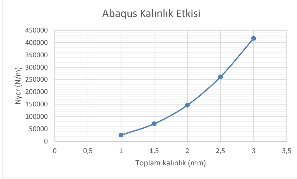
Şekil 7.7 : Sonlu eleman çözümünde kalınlık değişiminin burkulma yüküne etkisi
