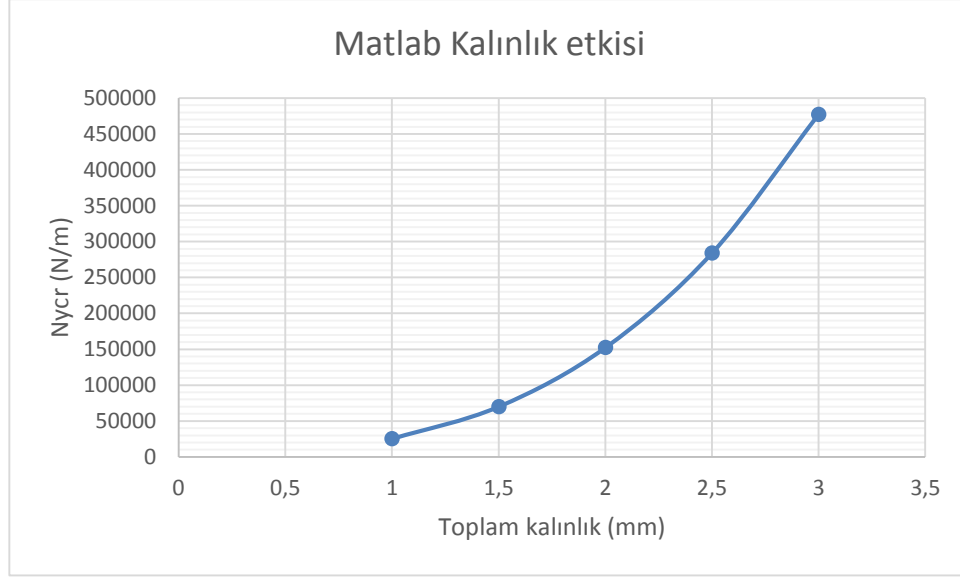
Şekil 7.6 : Analitik çözümde kalınlık değişiminin burkulma yüküne etkisi
