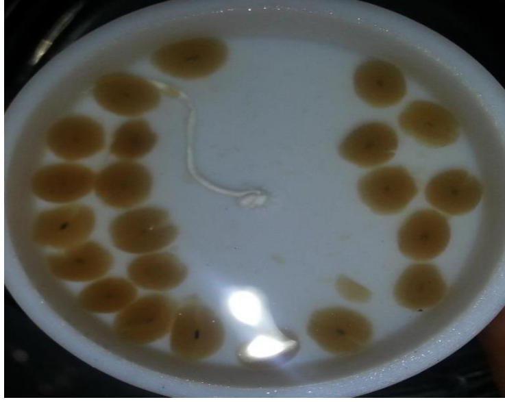
Şekil 3.4 : pH=7,4 tampon çözeltisinde parçalanan manyetik mikroküreler.
