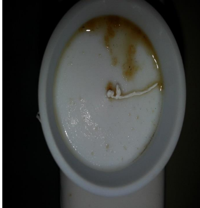
Şekil 3.5 : pH=7,4 tampon çözeltisinde tamamen parçalanan manyetik mikroküreler.
