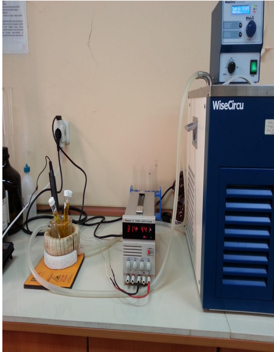
Şekil 3.6 : Şişme ve ilaç salım deneyleri için manyetik alan oluşturan sistemin görüntüsü.
