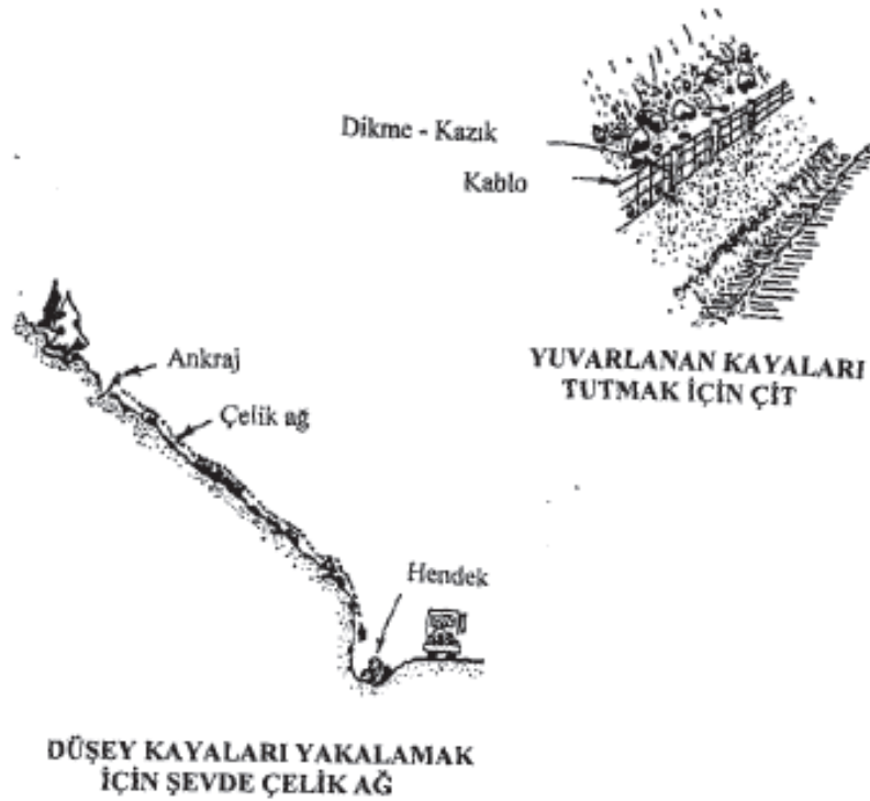
Şekil 4.28. Düşen kayaları yakalamak için şevde çelik ağ (Özsoy, 1998)
