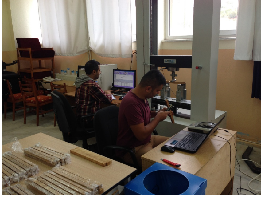
Şekil 3.8. Eğilme direnci ve elastikiyet modülü tayini
