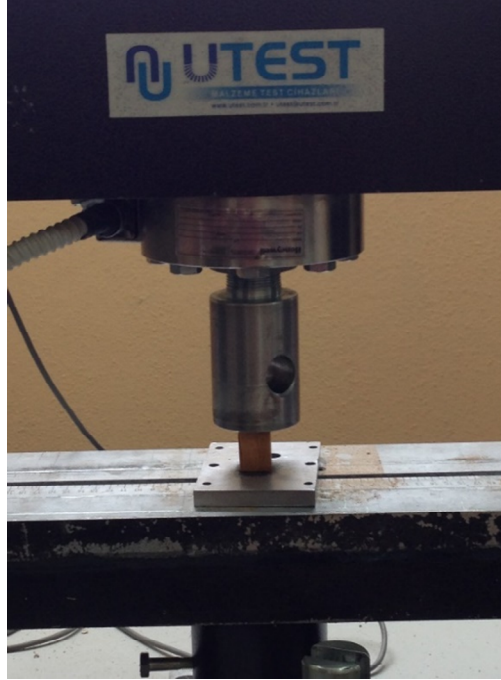
Şekil 3. 7. Liflere paralel yönde basınç direnci tayini
