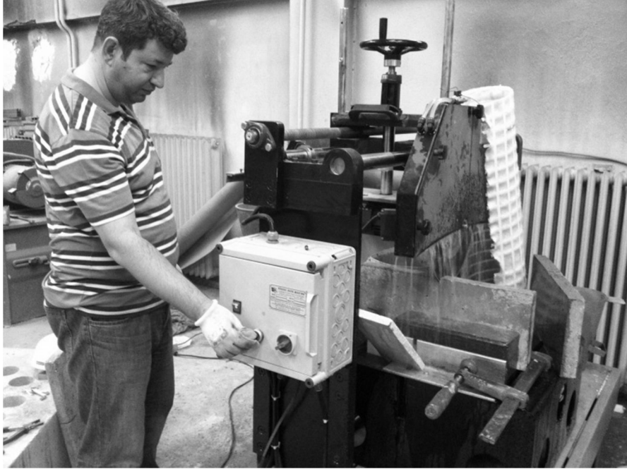
Resim 3.6. Çentik açma makinasında kesme hızı kontrolü
