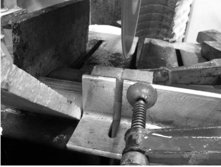
Resim 3.8. Çentik açılan deney elemanı (2)
