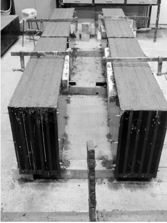
Resim 3.2. Döküm sonrası L=1200mm'lik kirişler
