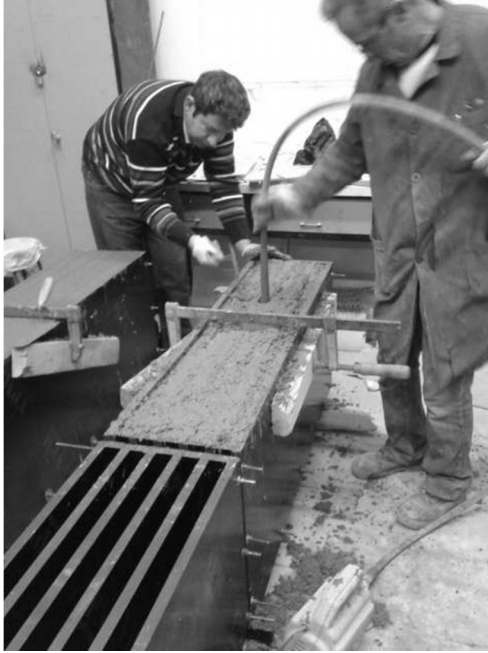
Resim 3.1. Beton kirişlerin dökümünde vibrator kullanımı
