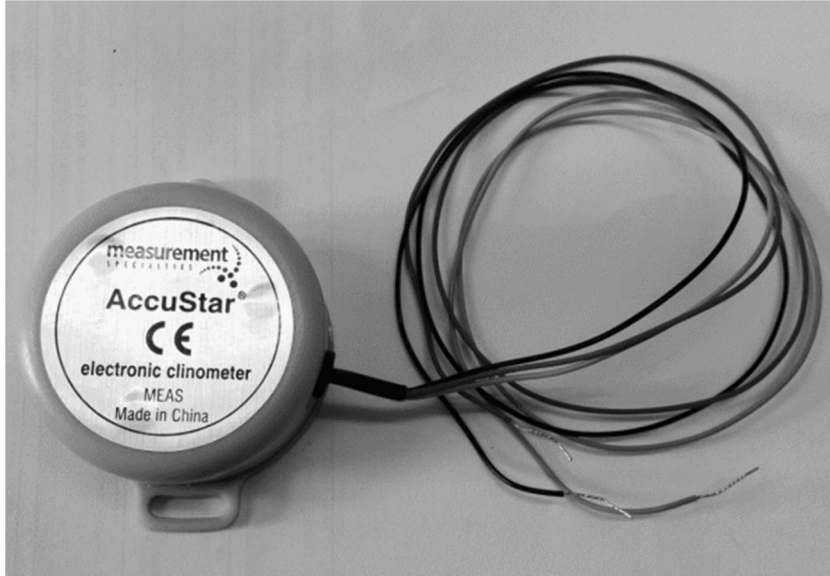
Resim 3.10. Deneylerde kullanılan eğimölçer sensörü
