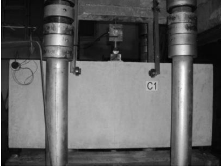
Resim 3.11. C1 elemanı yükleme düzeneği
