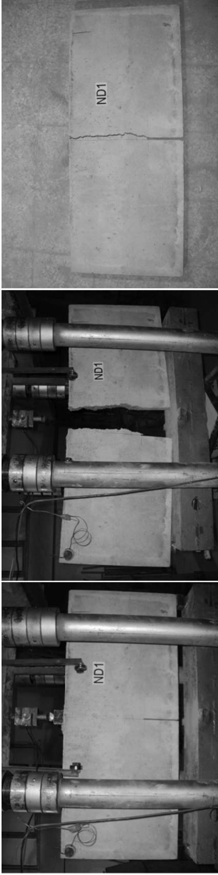
EK-1. (devam) Deney öncesi ve deney sonrası çatlak dağılımı
