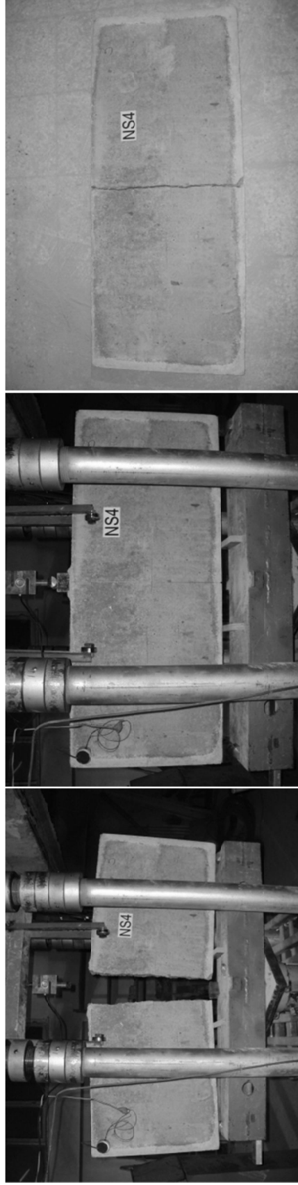
Resim 1.8. Sığ çentikli ( \alpha=0,02 ) NS4 kirişinin deney öncesi, kırılma sonrası ve çatlak dağılımı
