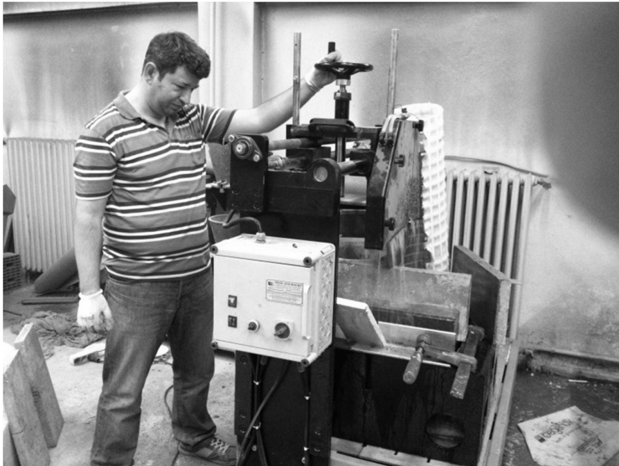
Resim 3.5. Çentik açma makinasında kesme yüksekliği kontrolü
