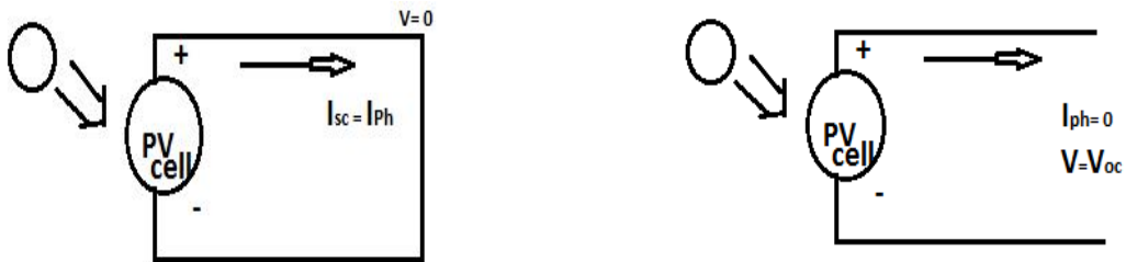
Şekil 4a: Kısa devredeki iletimini gösteren diyagram b: Açık devre iletimini gösteren diyagram
